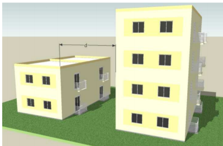
Figura 2 – Distância de segurança entre cobertura e fachada
