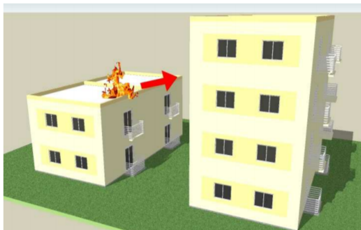
Figura 1 – Propagação entre cobertura e fachada
